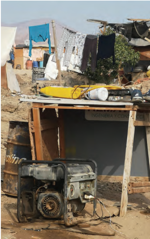
Figura 8. Moto-generador eléctrico de 2000 w, en reparación. Las Guaneras. Julio 2019.
