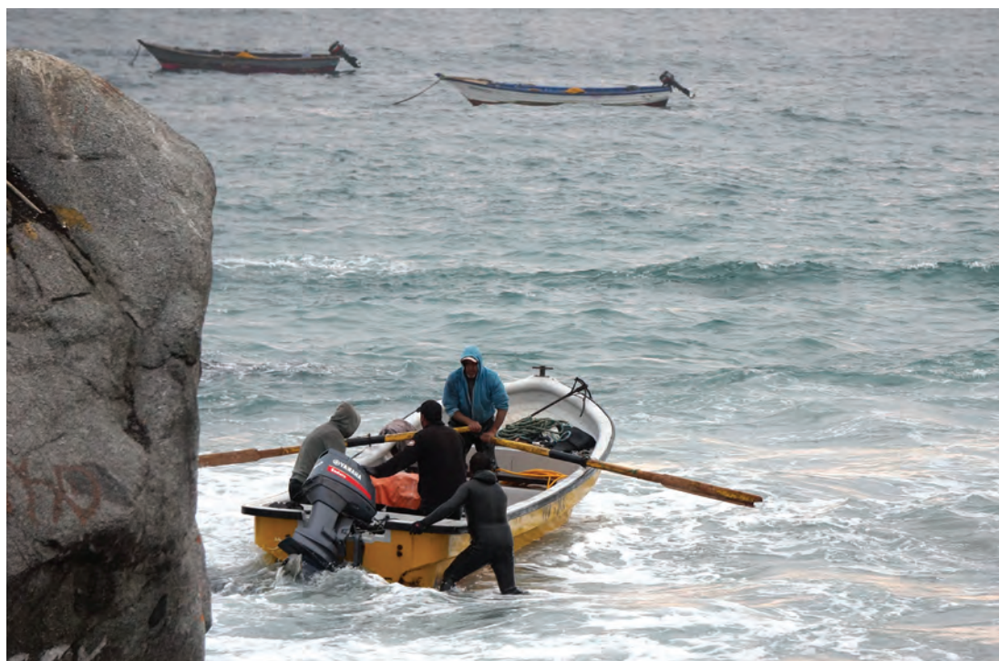
Figura 3. Bote de fibra de vidrio con motor de 60 hp. Guanillos. Julio 2019.
