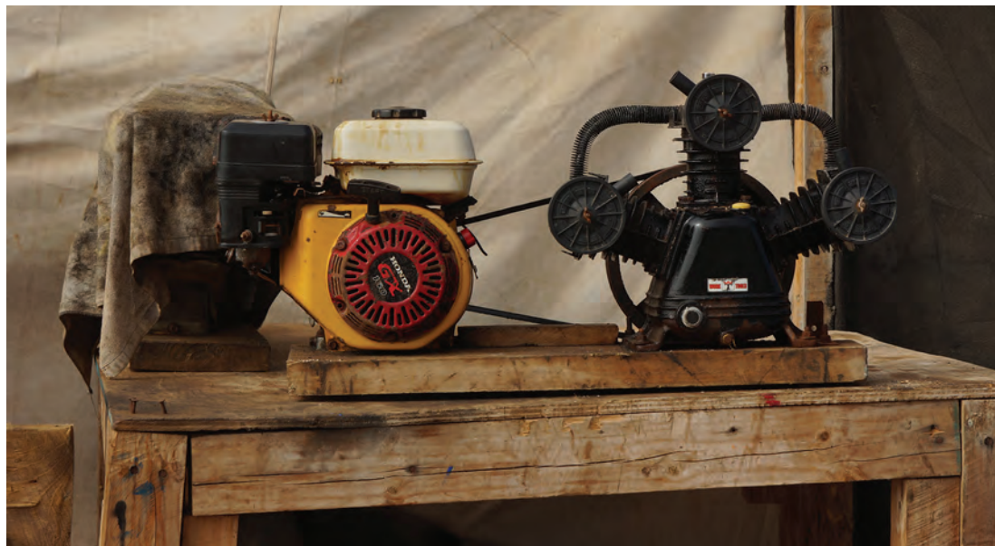
Figura 5. Compresor de aire artesanal: motor de 5 hp, correa y cabezal de compresión de 3 pistones sobre chasis de madera. Las Guaneras. Julio 2019.
